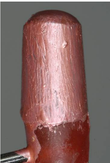
Abb. 19: Fertigungs-FEHLER: keine gleichmäßig konstante Schichtstärke des Silberleitlacks führt zu einem vergrößertem Fügespalt
